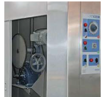
Puerta lateral para acceder al sistema de giro, el quemador y los controles en general.
