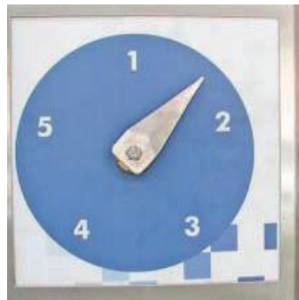
Indicador de posición de bandeja en el panel frontal.
