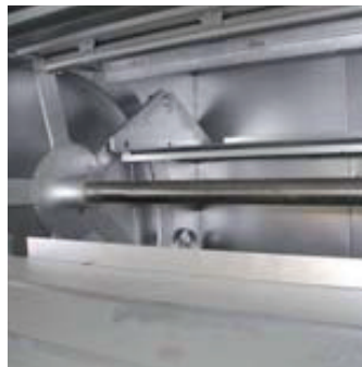
Sistema de giro con bandejas, en acero pintado y con ruedas estabilizadoras.
