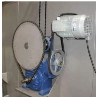
Sistema de rotación con motor eléctrico y reductor de velocidad.
