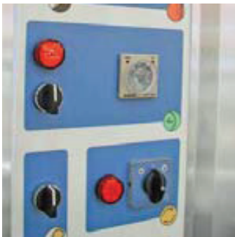
Panel frontal que controla temperatura, tiempo de horneado, dirección de giro, iluminación y encendido.
