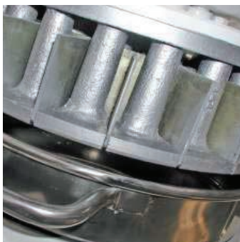
Cuchillas en acero ubicadas estratégicamente para garantizar que la masa se divida en partes iguales.
