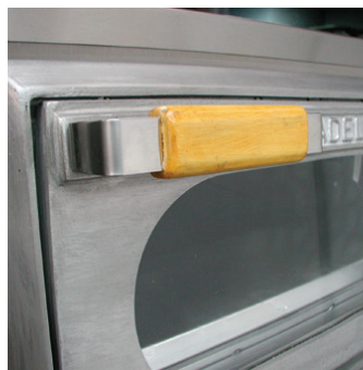
Manija de seguridad cubierta en madera para aislar la temperatura.
