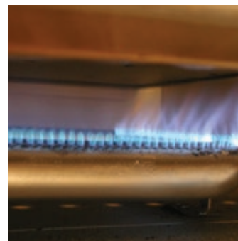
Quemadores industriales de alto poder que proveen una temperatura homogénea al interior de cámara.
